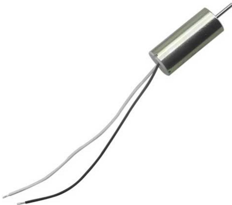
Motore di ricambio, con senso di rotazione antiorario, per quadricottero QX90. Diametro 8,5 mm, lunghezza 20 mm, diametro albero motore 1 mm, lunghezza fili (nero e bianco) 60 mm, peso: circa 5 grammi.
