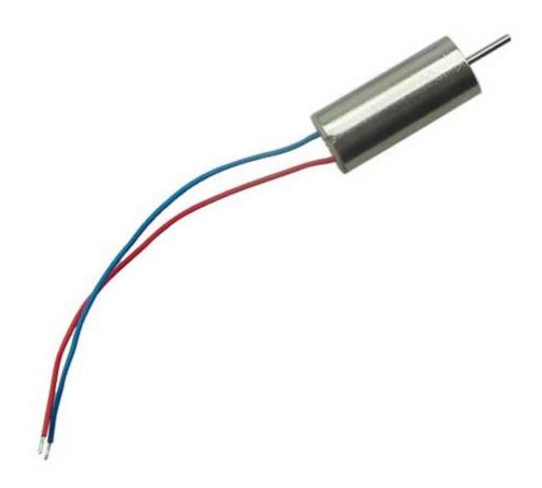
Motore di ricambio, con senso di rotazione orario, per quadricottero QX90. Diametro 8,5 mm, lunghezza 20 mm, diametro alberino motore 1 mm, lunghezza fili (blu e rosso) 60 mm, peso: circa 5 grammi.
