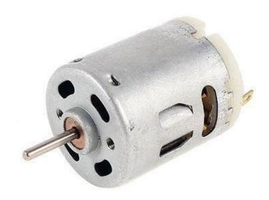
Motore con alimentazione compresa tra 6 e 12 VDC. Velocità a 6 VDC: 2000 rpm per un minuto, velocità a 12 VDC: 5000 rpm per un minuto. Consumo: 50 mA, dimensioni motore (mm): Ø 27,5x32,5, alberino: Ø 2,3x12, peso: circa 50 grammi.
