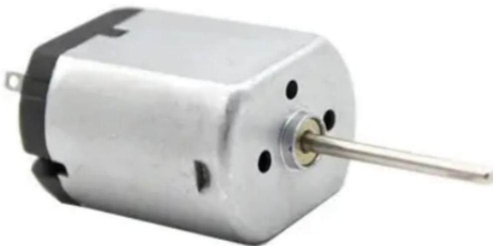
Motore con alimentazione compresa tra 6 e 12 VDC. Velocità a 6 VDC: 1650 rpm per un minuto, velocità a 12 VDC: 3300 rpm per un minuto. Consumo: max 24 mA, dimensioni motore (mm): 30,5x24x18,3, albero: Ø 2 x 22 (lunghezza), peso: circa 38 grammi.
