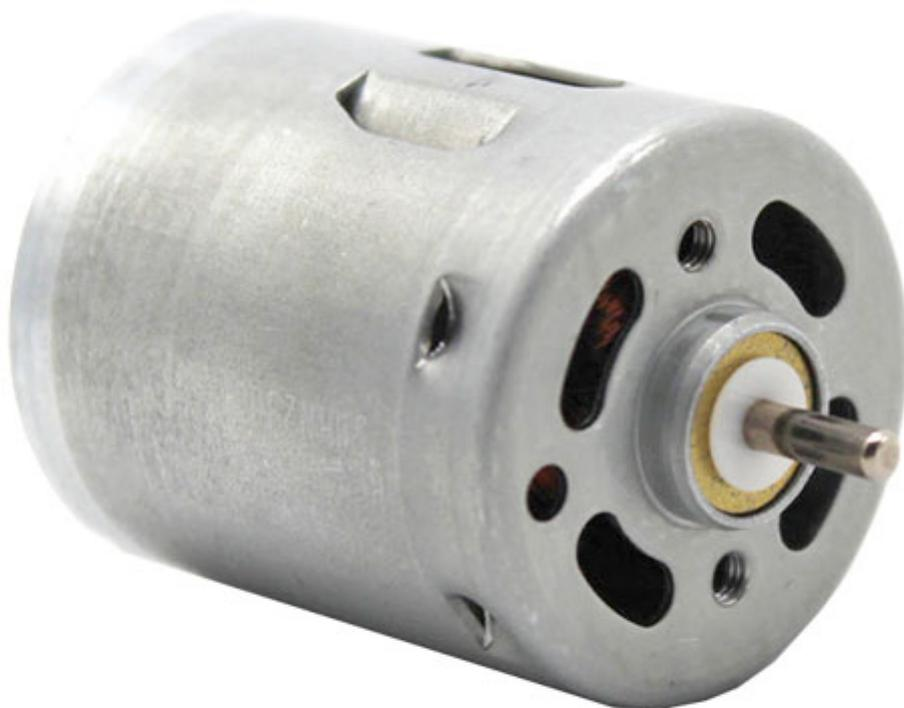
Motore con alimentazione compresa tra 6 e 12 VDC. Velocità a 6 VDC: 3000 rpm, velocità a 12 VDC: 6200 rpm. Consumo: max 750 mA, dimensioni motore (mm): 25,5 (diametro) x 31,0 (lunghezza), albero anteriore: Ø 2x9 (lunghezza), 2 fori (M2,5) di fissaggio sulla parte anteriore, peso: circa 45 grammi.
