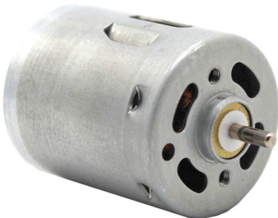
Motore con alimentazione compresa tra 6 e 12 VDC. Velocità a 6 VDC: 5500 rpm, velocità a 12 VDC: 9800 rpm. Consumo: max 750 mA, dimensioni motore (mm): 27,5 (diametro) x 37,80 (lunghezza), albero anteriore: Ø 2.20x13 (lunghezza), 2 fori (M2,5) di fissaggio sulla parte anteriore, peso: circa 70 grammi.
