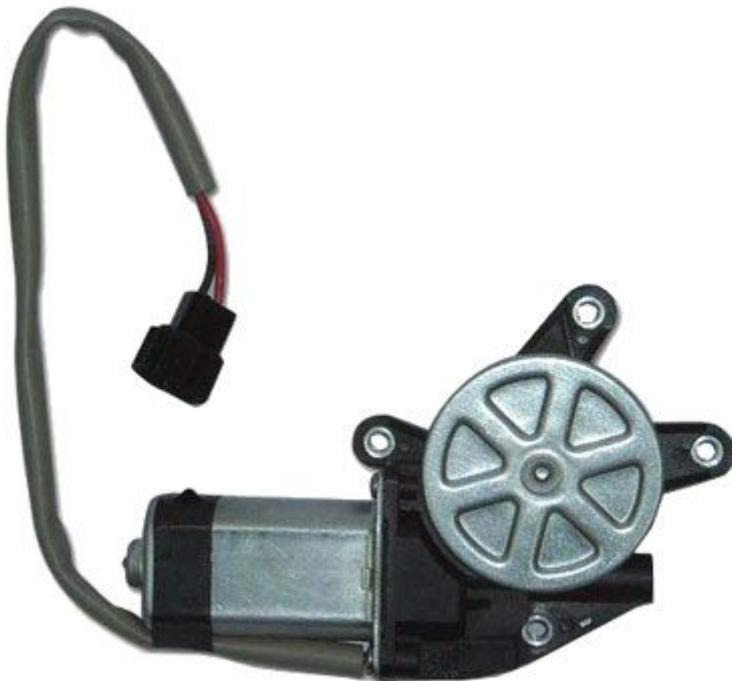
Potente motore DC, utilizzato come alzacristalli in alcuni modelli di auto straniere (lato destro). Alimentato a 12 VDC, assorbe meno di 3 A senza carico e ha una velocità di 85 rpm. Coppia di torsione: 30 kg cm. Peso: 1,8 kg. Particolarmente indicato per la realizzazione di Robot.
