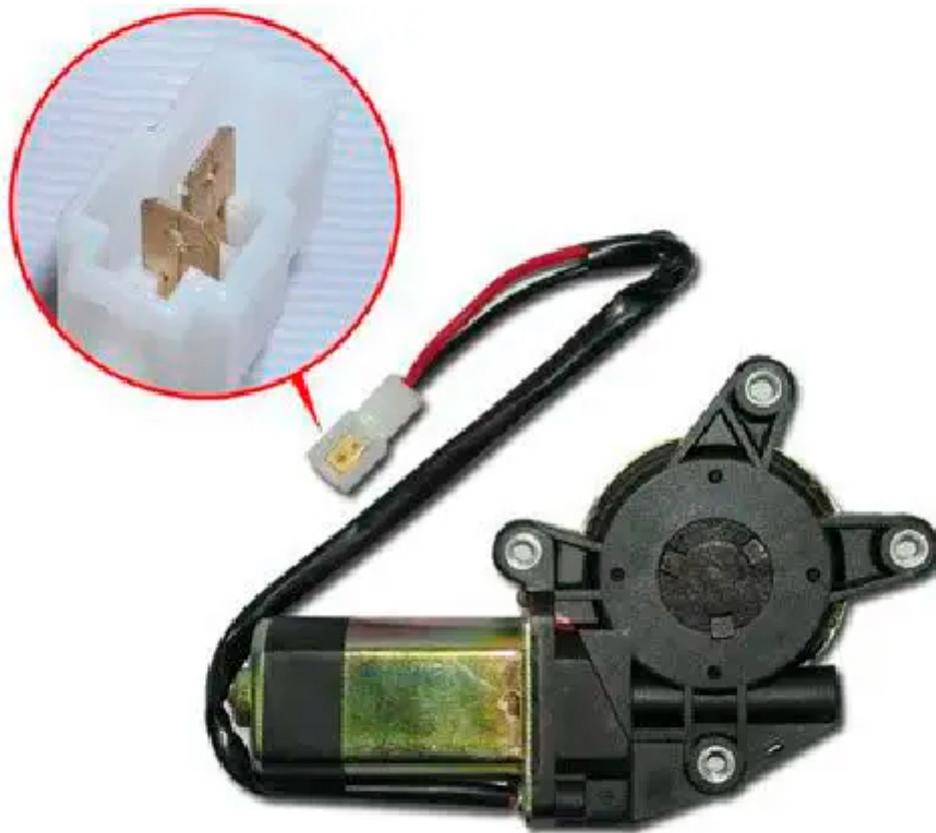
Potente motore DC, utilizzato come alzacristalli in alcuni modelli di auto straniere (lato sinistro). Alimentato a 12 VDC, assorbe meno di 3A senza carico e ha una velocità di 85 rpm. Coppia di torsione: 30 kg cm. Peso: 1,8 kg. Particolarmente indicato per la realizzazione di Robot.
