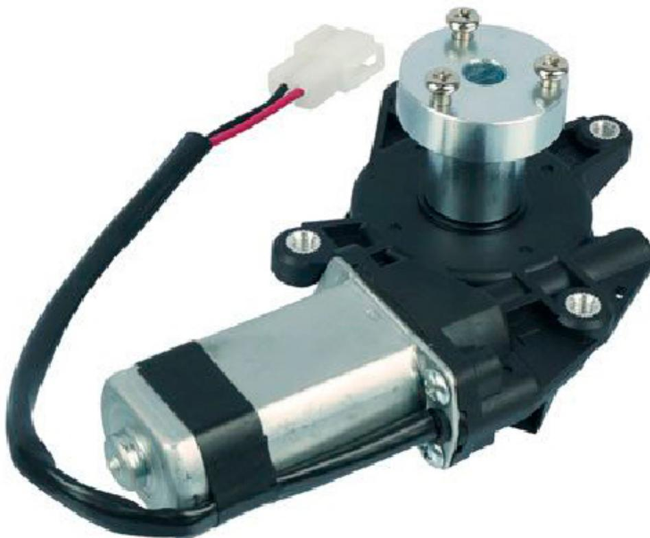
Potente motore DC, utilizzato come alzacristalli in alcuni modelli di auto straniere (lato sinistro), questa versione viene fornita con HUB per il montaggio di ruote. Alimentato a 12 Vdc, assorbe meno di 3A senza carico e ha una velocità di 85 rpm. Coppia di torsione: 30 kg cm. Peso: 1,8 kg. Particolarmente indicato per la realizzazione di Robot. **N.B.** la ruota non è compresa.
