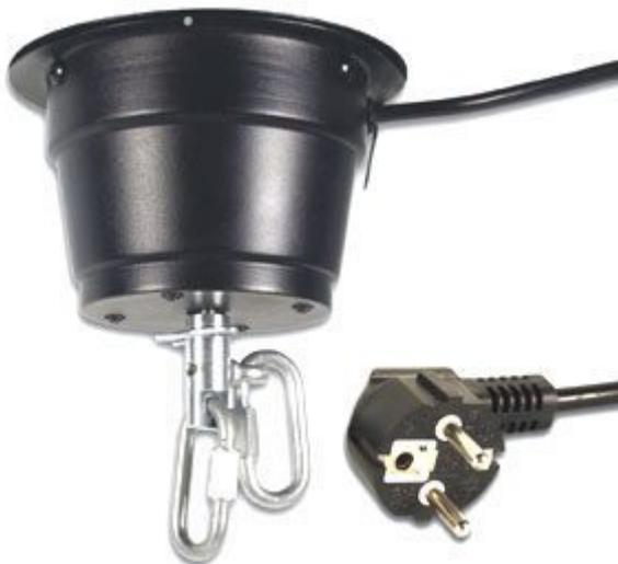
Permette di far ruotare una sfera a specchi con peso massimo di 10 kg. Alimentazione 230 Vac (cavo con spina tipo schuko); velocità di rotazione 3 rpm; dimensioni Ø140 x 85 mm. Dotato di attacco di sicurezza extra per l'utilizzo con le sfere a specchi VDL30MB, VDL30CMB e VDL50MB secondo le normative europee.
