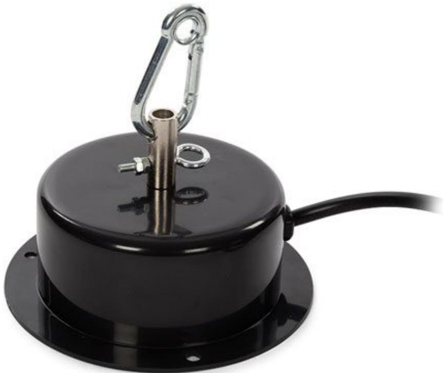
Questo motore permette di far ruotare una sfera a specchi con diametro max. 30 cm (12") e peso massimo di 3 kg. Alimentazione 220-240 VAC (cavo con spina tipo schuko); velocità di rotazione 3 giri al minuto; dimensioni (mm): Ø110x58, peso: 270 grammi.
