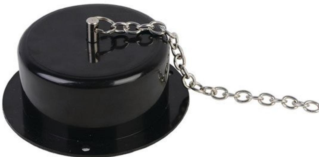
Questo motore permette di far ruotare una sfera a specchi con diametro max. 30 cm (12") e peso massimo di 4 kg. Alimentazione 220-240 VAC (cavo con spina tipo schuko); velocità di rotazione 1,5 giri al minuto; dimensioni (mm): Ø110x45, peso: 260 grammi. Fornito con accessori di montaggio e catena per sfera a specchi.
