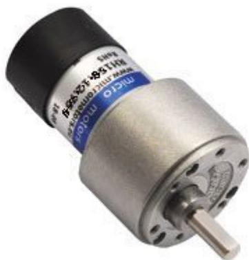
Motoriduttore a 12 Vdc con rapporto di riduzione 629,82:1, dotato di soppressore disturbi con VDR sul collettore, direzione di rotazione secondo polarità. Particolarmente indicato per la realizzazione di Robot.
