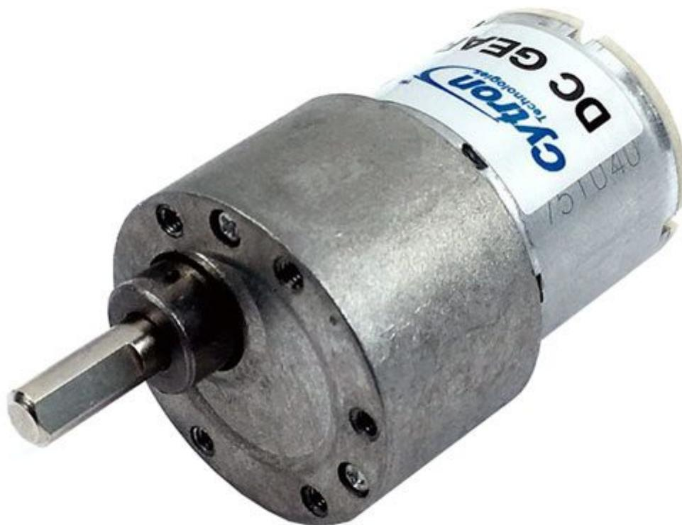
Motoriduttore a 12 Vdc con rapporto di riduzione 200:1, coppia massima di 68,7 N-cm, velocità senza carico: 22,5 rpm, direzione di rotazione secondo polarità. Particolarmente indicato per la realizzazione di Robot.
