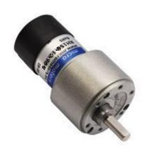
Motoriduttore a 12 Vdc con rapporto di riduzione 198,5:1, dotato di soppressore disturbi con VDR sul collettore, direzione di rotazione secondo polarità. Particolarmente indicato per la realizzazione di Robot. Utilizzato nel progetto "RASAERBA AUTOMATICO A ENERGIA SOLARE" pubblicato sul numero 139 della rivista Elettronica In ~ Luglio / Agosto 2009.
