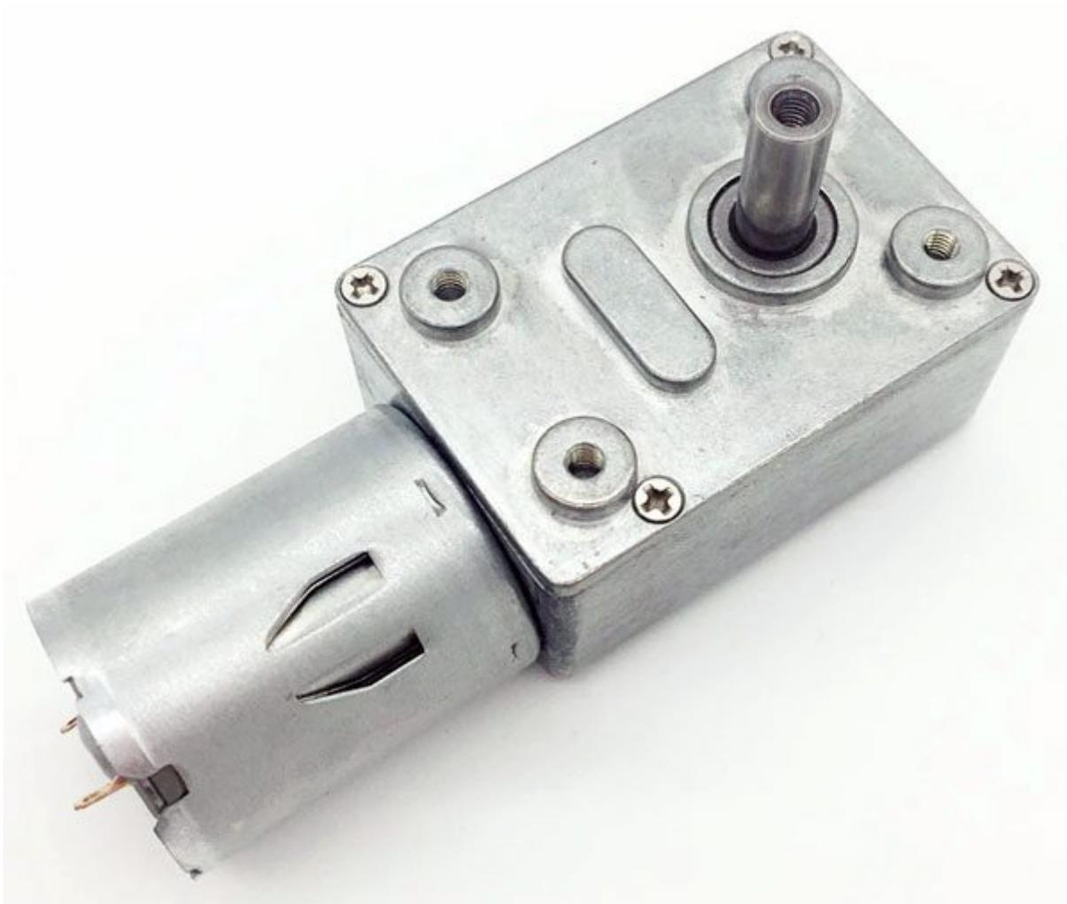
Motoriduttore a 12 Vdc con rapporto di riduzione 200:1, coppia massima di 7,4 kg-cm, velocità senza carico: 30 rpm, direzione di rotazione secondo polarità. Particolarmente indicato per la realizzazione di Robot, automazione, ecc.
