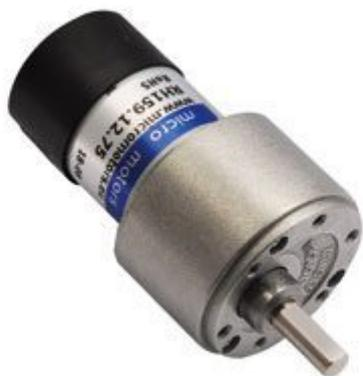
Motoriduttore a 12 Vdc con rapporto di riduzione 76,84:1, dotato di soppressore disturbi con VDR sul collettore, direzione di rotazione secondo polarità. Particolarmente indicato per la realizzazione di Robot.
