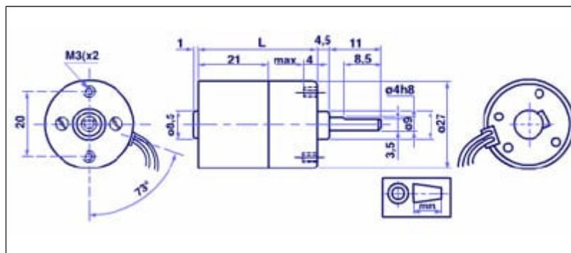
Motoriduttore a 12 Vdc con rapporto di riduzione 43:1, dotato di soppressore disturbi con VDR sul collettore, direzione di rotazione secondo polarità. Particolarmente indicato per la realizzazione di Robot. Utilizzato nel progetto robot RUN, pubblicato sulla rivista *ElectronicaIn* n° 111 e robot FOX (*ElectronicaIn* n°112).
