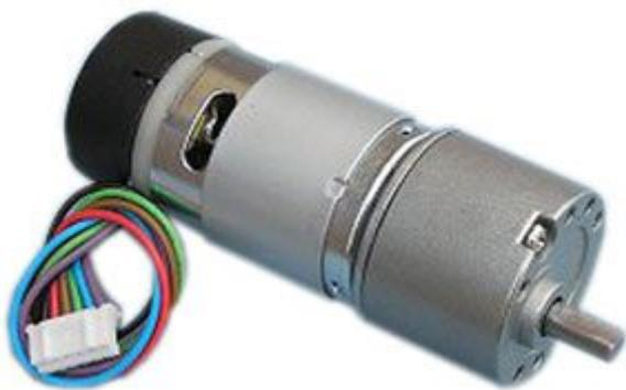
Motoriduttore a 12 Vdc con encoder ad effetto di Hall, rapporto di riduzione 30:1, dotato di condensatore per la soppressione dei disturbi. Particolarmente indicato per la realizzazione di Robot.
