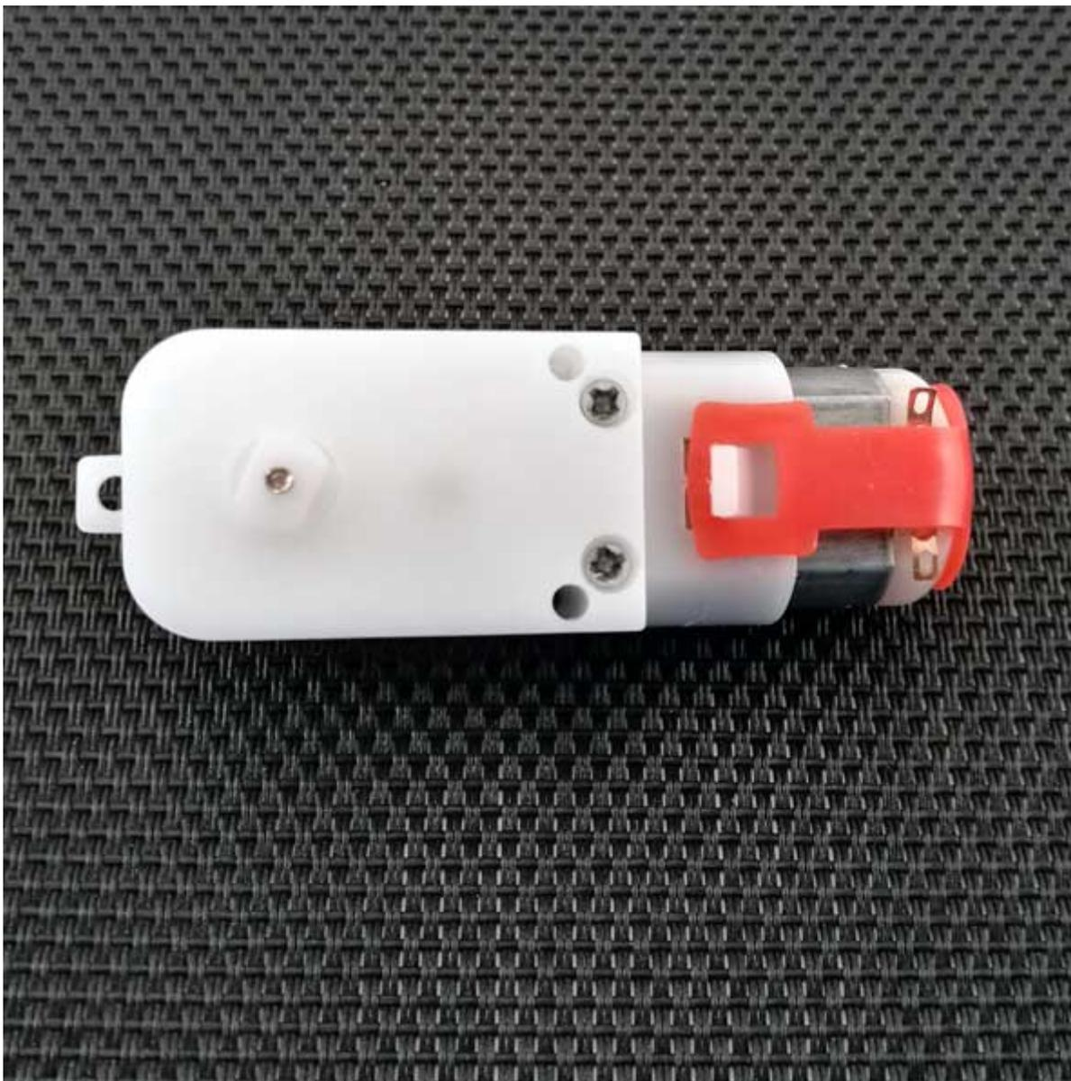
Motoriduttore con rapporto di riduzione 202,8:1, velocità 65 rpm a 3 VDC e 120 rpm a 6 VDC. Alimentando il motoriduttore a 6 VDC il consumo è di 320 mA. Dimensioni (mm): 65x50x22,5x21, peso 31,5 grammi. Particolarmente indicato per la realizzazione di Robot. La tensione di alimentazione consigliata per questo motore è da 3 a 6 V.
