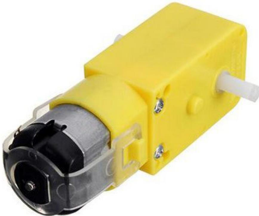
Motoriduttore con doppio alberino, rapporto di riduzione 48:1, velocità 130 rpm (a 6 VDC). Alimentando il motoriduttore a 6 VDC il consumo è di 130 mA. Dimensioni (mm): 70x36x22, peso 26 grammi. Particolarmente indicato per la realizzazione di Robot. La tensione di alimentazione consigliata per questo motore è da 3 a 6 V. Indicato per essere utilizzato in abbinamento alle ruote 9145-2RUOTE24WD (non comprese).
