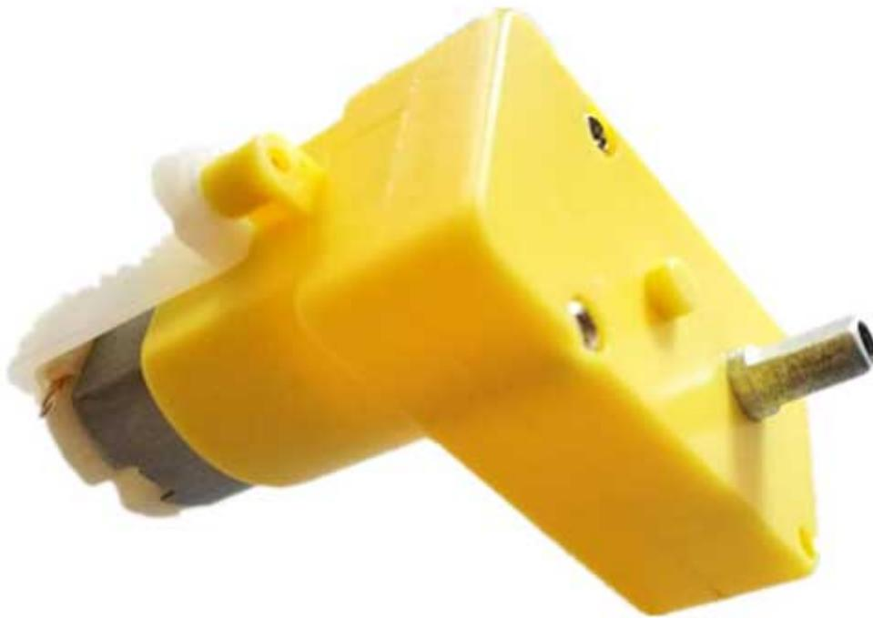
Motoriduttore con alberino in metallo, rapporto di riduzione 120:1, velocità 200 rpm (a 6 VDC). Alimentando il motoriduttore a 6 VDC il consumo è di 200 mA. Dimensioni (mm): 56x50x23, peso 33 grammi. Particolarmente indicato per la realizzazione di Robot. La tensione di alimentazione consigliata per questo motore è da 3 a 6 V. Indicato per essere utilizzato in abbinamento alle ruote 9145-2RUOTE24WD (non comprese).
