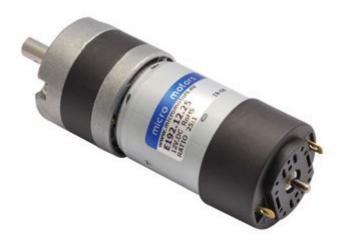
Motoriduttore planetario a 12 Vdc con rapporto di riduzione 25:1, albero di uscita supportato da due cuscinetti a sfera. Dotato di soppressore disturbi con VDR sul collettore e condensatori, direzione di rotazione secondo polarità. Particolarmente indicato per la realizzazione di Robot.
