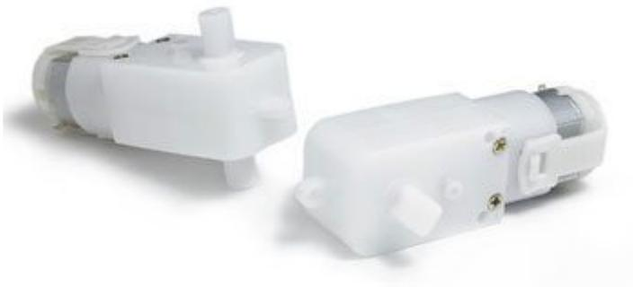
Il motoriduttore Solarbotics GM3 è un'alternativa a basso costo ai servo modificati (rotazione continua). Il rapporto di riduzione è di 224:1 con una velocità di 38 rpm (leggermente più lento di un servo), l'alimentazione è di soli 5 Vdc con un consumo di 52 mA (600 mA in stallo), dimensioni 70 mm x 22,5 mm x 37 mm. Particolarmente indicato per la realizzazione di Robot. La confezione comprende un solo GM3.
