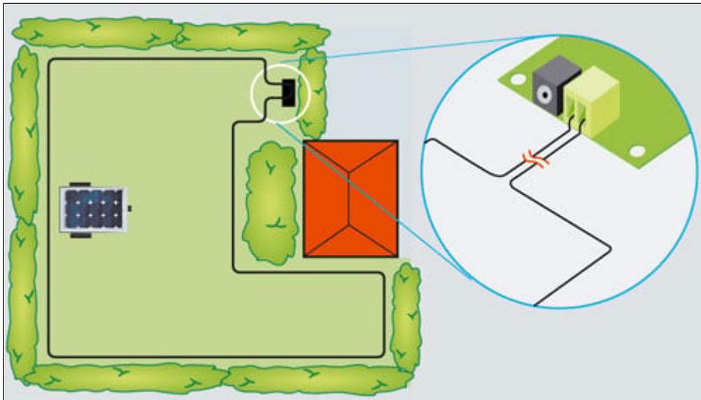
Il recinto entro cui il rasaerba si sposterà si definisce posando (interrato di qualche centimetro ad evitare che le ruote o la lama lo tocchino) sotto l'erba un filo elettrico che parte da uno dei morsetti del circuito generatore e si chiude sull'altro, a formare un anello. In questo modo, la corrente nel filo indurrà nei dintorni un campo elettromagnetico a 34 kHz, rilevabile dalle induttanze (1mH?) del rasaerba (che sono poste nella parte più bassa della scocca).
