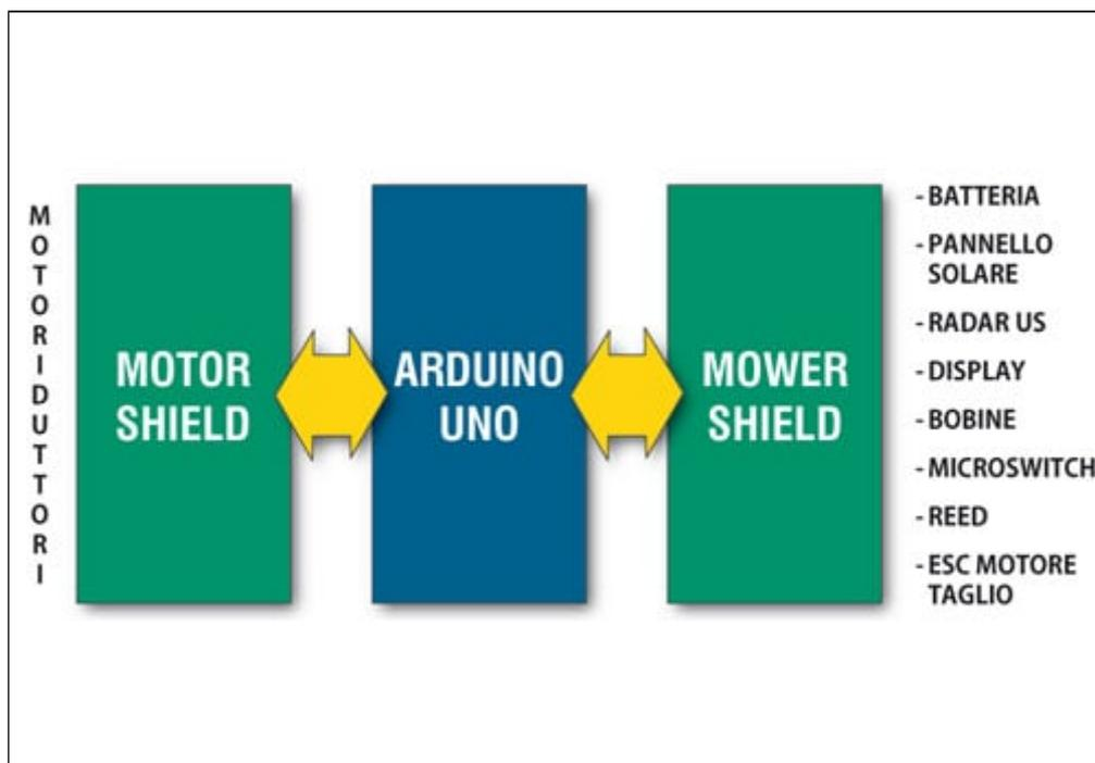
L'elettronica del robot è composta da Arduino UNO su cui sono applicati un Motorshield e il Mowershield\_FE: al primo si collegano i motoriduttori delle ruote, al secondo tutto il resto.
