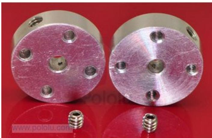
Mozzo universale in alluminio progettato per essere impiegato con la maggior parte degli alberi da 3 millimetri dei motori, compresi alberi rotondi, alberi a "D" e alberi esagonali come quelli della Tamiya. Ogni mozzo ha quattro fori filettati per il montaggio di ruote o meccanismi. Un grano per ogni mozzo garantisce l'accoppiamento tra albero e mozzo. È necessaria una chiave a brugola da 1,3 mm. La confezione comprende: 2 mozzi e 2 grani.
