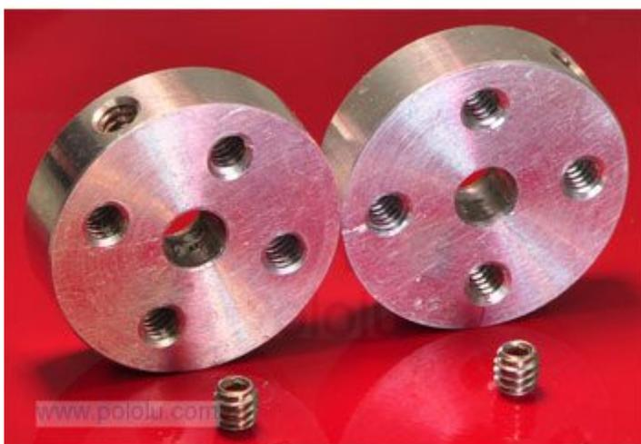
Mozzo universale in alluminio progettato per essere impiegato con la maggior parte degli alberi da 4 millimetri dei motori, compresi alberi rotondi, alberi a "D" e alberi esagonali come quelli della Tamiya. Ogni mozzo ha quattro fori filettati per il montaggio di ruote o meccanismi. Un grano per ogni mozzo garantisce l'accoppiamento tra albero e mozzo. È necessaria una chiave a brugola da 1,3 mm. La confezione comprende: 2 mozzi e 2 grani.
