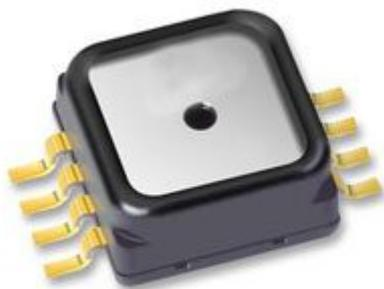
L'MPXH6115A6U è un circuito integrato per la misura della pressione atmosferica, alimentato con una tensione di 5V, garantisce un'accuratezza di  $\pm 1.5\%$  di VFSS (differenza algebrica tra la tensione d'uscita al valore massimo e minimo di pressione). La linearizzazione viene effettuata direttamente dal circuito integrato e non è necessaria alcuna taratura o regolazione dell'offset.
