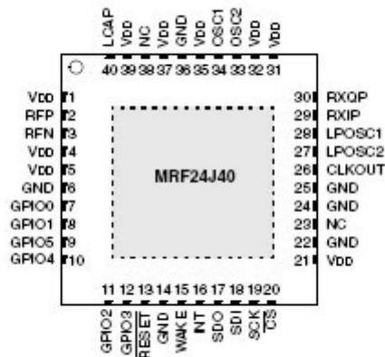
Il Chip MRF24J40 è un trasmettitore/ricevitore integrato della Microchip, particolarmente indicato per creare applicazioni RF basate sui protocolli di comunicazione MiWi o ZigBee. Contenitore SMD tipo QFN 40 pin.
