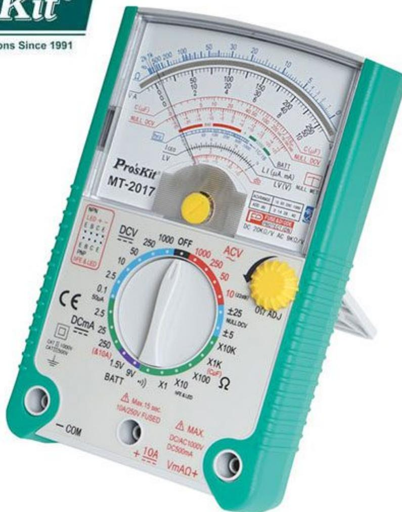
Multimetro analogico (CE/CAT II 1000V, CAT III 500V) in grado di misurare correnti continue fino a 10 A, tensioni continue e alternate fino a 1000 V, resistenze fino a 20 Mohm, diodi, transistor e continuità elettrica. Alimentazione: 2 batterie da 1,5 volt tipo AAA; 1 batteria transistor da 9 volt (batterie non incluse). Il tester viene fornito completo di puntali e di fusibili di ricambio 0.5A/250V - 10A/250V.
