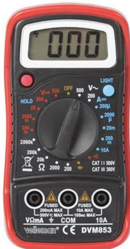
Multimetro digitale 19 range CAT. III 300 V / CAT. II 500 V, con display LCD a 3 cifre 1/2 retroilluminato in grado di misurare correnti continue fino a 10 A, tensioni continue e alternate fino a 500 V, resistenze fino a 2 Mohm, diodi, transistor e continuità elettrica. Dispone di riconoscimento automatico della polarità e indicazione di batteria scarica. Alimentazione con batterie tipo AAA (incluse). Completo di guscio di protezione.
