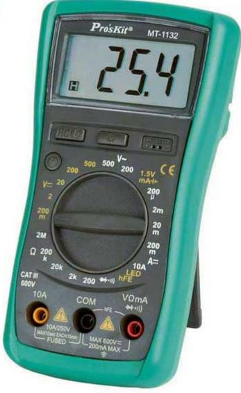
Multimetro digitale 20 range (CAT. III 1000V), con ampio display LCD a 3 cifre 1/2 (altezza cifre 15 mm) retroilluminato in grado di misurare correnti continue fino a 10 A, tensioni continue e alternate fino a 500 V, resistenze fino a 2 Mohm, diodi, hFE dei transistor, LED e continuità elettrica. Dispone di indicazione di batteria scarica e protezione sovraccarico. Alimentazione con 2 batterie da 1,5 volt tipo AA (non incluse – vedere prodotti correlati). Completo di guscio di protezione.
