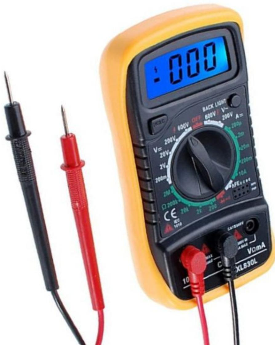
Multimetro digitale CAT. II 600 V, con display LCD a 3 cifre 1/2 retroilluminato in grado di misurare correnti continue fino a 10 A, tensioni continue e alternate fino a 600 V, resistenze fino a 2 Mohm, diodi, transistor e continuità elettrica. Dispone di riconoscimento automatico della polarità e indicazione di batteria scarica. Alimentazione con batteria 9V (non inclusa). Completo di guscio di protezione e puntali rimovibili.
