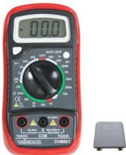
Multimetro digitale con display LCD a 3 cifre 1/2 retroilluminato in grado di misurare correnti continue fino a 10 A, tensioni continue e alternate fino a 600 V, resistenze fino a 2 Mohm, diodi, transistor e continuità elettrica. Dispone di riconoscimento automatico della polarità e indicazione di batteria scarica. Alimentazione con batteria a 9V (inclusa). Completo di guscio di protezione.
