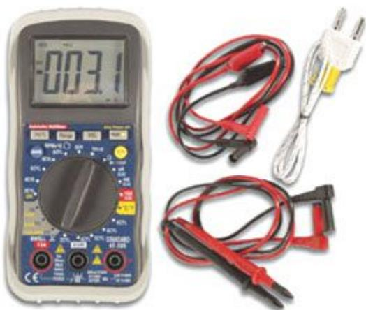
Multimetro digitale con display LCD retroilluminato a 4 cifre, selezione manuale/automatica delle portate, protezione contro i sovraccarichi. Misura il numero di giri/minuto da 500 a 9999, Dwell, frequenza, tensioni/correnti alternate e continue, resistenza, capacità, diodi e continuità. Alimentazione con batteria a 9 V.
