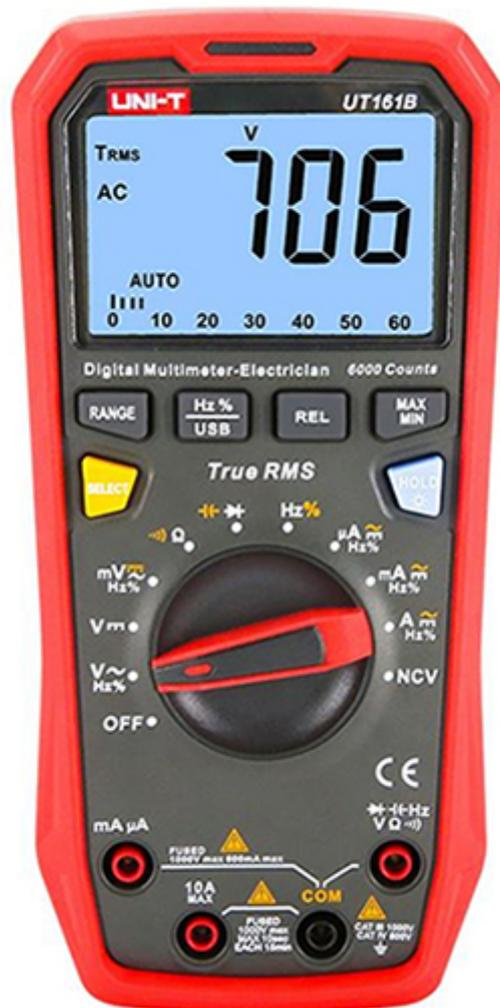
Multimetro digitale portatile True RMS con una capacità di 6000 conteggi, caratterizzato da una elevata affidabilità e sicurezza. Questo strumento è dotato di un ampio display LCD con retroilluminazione che include una barra analogica a 31 segmenti ad alta risoluzione. Grazie alla protezione da sovraccarico su tutta la scala e al suo design, si presenta come un pratico strumento di misurazione per l'hobbista e il professionista.
