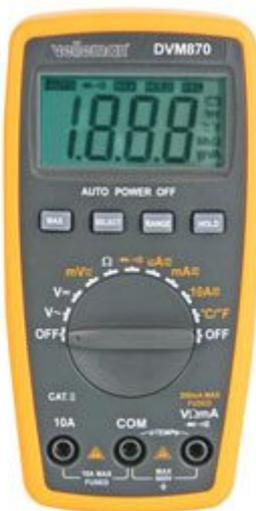
Strumento dalle caratteristiche professionali dotato di display LCD a 3½ cifre con indicazione automatica della polarità. La selezione delle portate può essere effettuata in modo manuale o automatico. Permette di misurare tensioni in AC e DC, correnti in AC e DC, resistenze e temperature. Dispone di funzione data Hold, fusibile autoripristinante (tranne portata 10 A) test continuità e diodi. Alimentazione con 2 batterie AAA (LR03C, non incluse). Completo di guscio di protezione.
