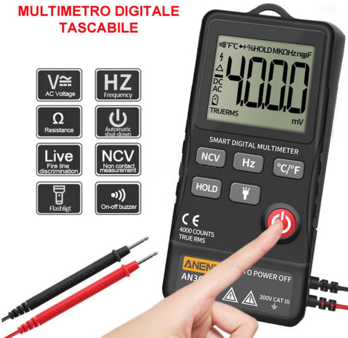
Multimetro digitale con ampio display LCD, tascabile e ultrasottile. È in grado di misurare tensioni continue e alternate fino a 310 V, resistenze fino a 40 Mohm, frequenze fino a 100 kHz, continuità elettrica. Dispone di cambio automatico della portata, torcia LED, rilevamento senza contatto NCV (Non-contact Detection), indicazione temperatura ambiente, spegnimento automatico e indicazione di batteria scarica. Alimentazione con batteria 3V CR2032 (non inclusa).
