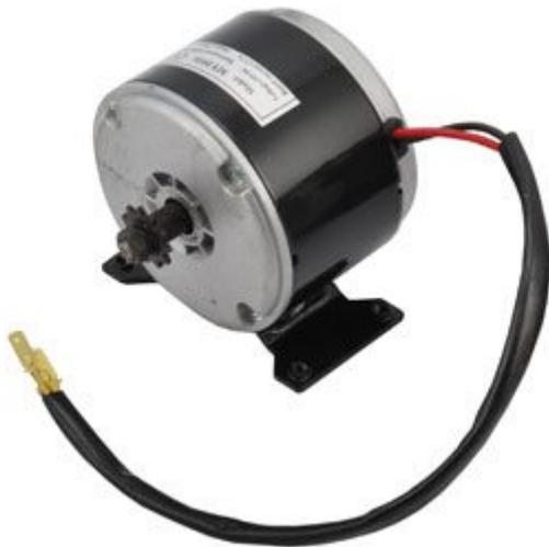
Motore a spazzole con alimentazione a 24 Vdc, 350 watt di potenza e una velocità di 2650 rpm (25-35 km/h). Massimo carico: 80 kg, diametro corpo motore: 101 mm, altezza: 104 mm, lunghezza: 92 mm, peso: 2,3 kg.
