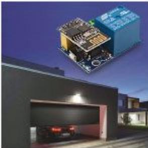
**ESP smart relé** Controllato da smartphone o comandi vocali, supporta le modalità Smart lock e Smart switch: la prima è una serratura elettronica per l'apertura di varchi motorizzati e la seconda è un interruttore per l'accensione di un punto luce.
