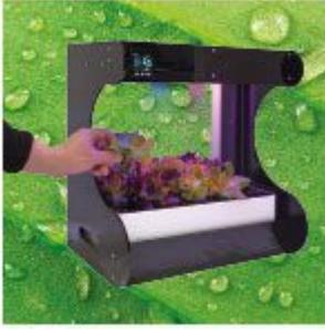
**Serra domotica per coltura idroponica** Costruiamo una serra domotica (comandata da relativa app) con illuminazione artificiale a LED specifici per ottimizzare la crescita delle piante contenute, utilizzando la tecnica idroponica. Prima puntata.
