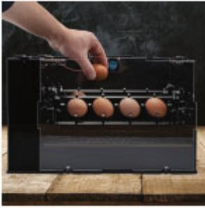
**Incubatrice automatica con ESP32-CAM** Incubatrice per uova di gallina completamente automatizzata con controllo di temperatura, umidità e rotazione delle uova; il sistema è monitorabile tramite un bot Telegram con l'invio di messaggi e immagini.
