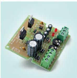
**Alimentatore stabilizzato duale e regolabile** Con l'aggiunta di un trasformatore dotato di presa centrale, consente di fornire tensioni stabilizzate simmetriche da 3 a 15 Vcc e correnti di 1 A. Ideale come apparato da banco, può costituire lo stadio di alimentazione di amplificatori BF.
