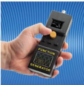
**Generatore di funzioni con ad9833** Sviluppa forme d'onda sinusoidale, triangolare e quadra a frequenza regolabile fra 1 Hz e 12 MHz.
