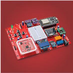
**Demoboard ESP32** Scopriamo i mille risvolti applicativi di uno dei più utilizzati moduli WiFi con una scheda di prototipazione che può ospitare e gestire sensori e attuatori sperimentabili con firmware di test da noi scritti appositamente. Prima puntata.
