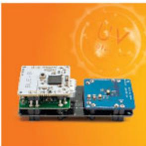
**Sensore UV Bluetooth** Realizziamo un rilevatore di radiazioni UV con allarme su smartphone tramite l’utilizzo di moduli Blebricks.
