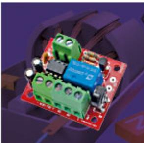
**Protezione undervoltage** Applicato ad un circuito in corrente continua, sconnette il carico tramite un relé quando la tensione di alimentazione scende al di sotto di un certo valore.
