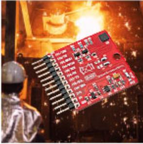
**Breakout ADT7422** Facilita la prototipazione e la sperimentazione con l'integrato sensore di temperatura di Analog Devices, rendendone disponibili i pin su uno strip e provvedendo all'alimentazione.
