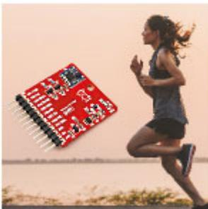
**Contapassi elettronico** Utilizziamo un modulo accelerometro MEMS montato su breakout board, interfacciato tramite I<sup>2</sup>C-Bus ad una board Arduino per rilevare e contare i passi durante la giornata, un'attività fisica o il lavoro.
