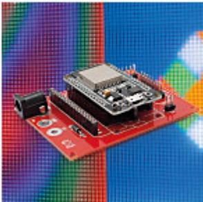
**LED matrix con ESP32** Pilotiamo una matrice di LED RGB standard tramite bus seriale utilizzando una scheda ESP32, con la possibilità di scegliere tra più versioni.
