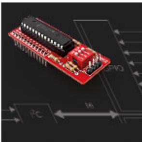
**Breakout per MCP23017** Sperimentiamo con il popolare I/O expander della Microchip, attraverso una scheda applicabile anche su breadboard, interfacciabile con Arduino.
