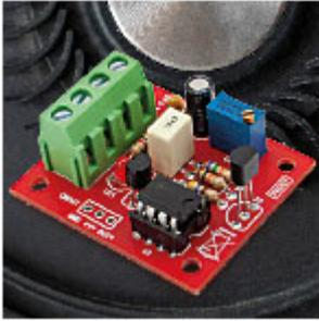
**Controllo automatico ventilazione** Basato sull'integrato LM35, accende e spegne l'elettroventola di un sistema di raffreddamento per elettroniche in funzione della temperatura rilevata.
