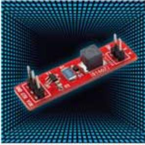
**Mini driver LED** I LED sono diventati sempre più comuni nell'elettronica di consumo, ma per farli funzionare in modo efficiente e sicuro, è necessario utilizzare un driver LED.
