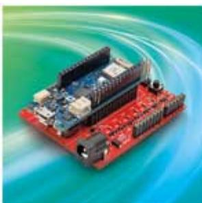
**MKR-UNO Arduino Shield** Adattatore che consente la compatibilità tra la serie di board MKR e gli shield di Arduino UNO..
