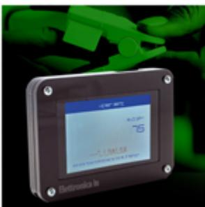
**Heart rate monitor** Colleghiamo un pulsiossimetro a un modulo ESP32, che invierà tramite BLE i dati sulla frequenza cardiaca ad un touch LCD basato su ESP32-S3
