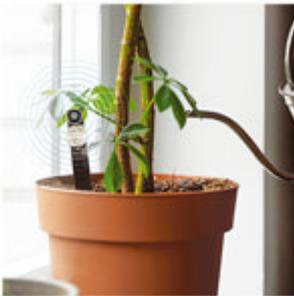
**Allarme per annaffiatura piante** Introdotto nella terra del vaso o fioriera, emette un suono tramite un cicalino piezo quando rileva che è poco umida per poter mantenere le piante in vita e in salute.
