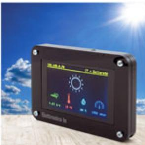
**Stazione meteo con ESP32** Sfruttiamo le potenzialità di un modulo display con SoC ESP32 integrato per visualizzare le condizioni e previsioni del tempo fornite dal servizio OpenWeatherMap, cui accediamo da WiFi.
