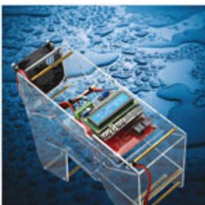
**Creiamo l'acqua dall'aria** Condensa l'aria che passa sul suo dissipatore raffreddato da una cella di Peltier ricavando acqua dall'umidità; è una sorta di deumidificatore che può funzionare alimentato da fotovoltaico per avere acqua dove non c'è.
