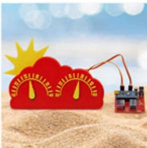
**Termoigrometro a lancette** È digitale o è analogico? Questo strumento è entrambe le cose, perché acquisisce temperatura e umidità attraverso sensori digitali e li elabora tramite Arduino, ma poi li rende visibili azionando due lancette con altrettanti servocomandi.
