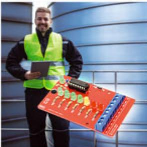
**Indicatore di livello liquidi** Rileva, mediante una serie di elettrodi e segnala con altrettanti diodi luminosi, il livello del liquido contenuto in una cisterna, vasca o serbatoio.
