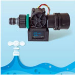
**Misuratore di flusso** Due implementazioni differenti per misurare la quantità d'acqua prelevata da un rubinetto grazie ad un economico flussimetro, per poi visualizzarla su un display OLED o monitorarla comodamente in remoto.
