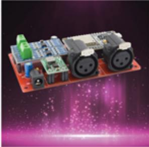
**Convertitore ArtNet-DMX basato su ESP32** Realizziamo un dispositivo in grado di ricevere i segnali di due universi ArtNet e di trasformarli in due universi DMX
