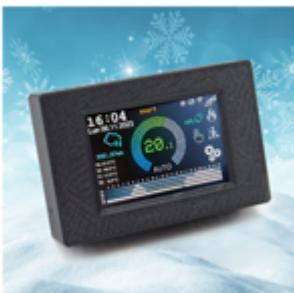
**Crono Termostato smart** Costruiamo un termostato avanzato dotato di un display LCD a colori touchscreen, rilevazione dell'umidità, stazione meteorologica e in grado di interagire con assistenti vocali.
