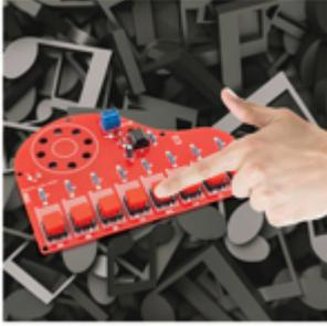
**Mini piano elettronico** Permette di suonare le 7 note base corrispondenti ciascuna a un pulsante, con un circuito basilare basato sull'immane 555.
