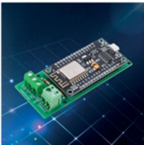
**Domotica con Grafana** Utilizziamo Grafana, software di supervisione open source, e un NODE MCU con ESP8266, per monitorare i dati di un inverter fotovoltaico, l'assorbimento di una pompa di calore e la temperatura dell'acqua del solare termico.
