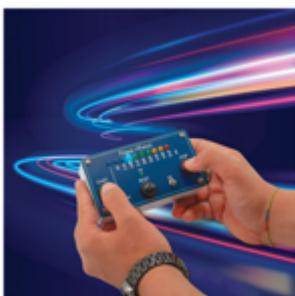
**Prova i riflessi con il timer 555** Utilizziamo il timer 555 e un circuito integrato CMOS per misurare i riflessi attraverso due pulsanti e visualizziamo i risultati su una scala di LED.
