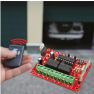
**Ricevitore 2 CH 434 MHz** Abbinato a un trasmettitore codificato EMYLO bicanale o a due TX monocanale, consente di controllare a distanza utilizzatori mediante due relé in modalità impulsiva o bistabile.
