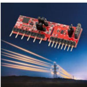
**Energy meter duale** Utilizziamo il nuovo MCP39F511N di Microchip per calcolare le potenze apparenti, attive e reattive di due carichi distinti, rendendo disponibili le misure via USB per visualizzarle tramite un apposito software. Prima puntata.
