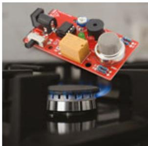
**Rilevatore di gas** Fornisce un avviso nel caso l'ambiente in cui è posizionato contenga gas in misura superiore alla soglia di pericolosità; idoneo a rilevare le fughe di GPL, metano ecc.
